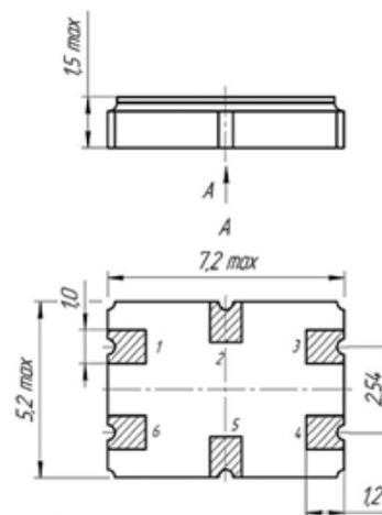
**ПРИМЕР УСЛОВНОГО ОБОЗНАЧЕНИЯ: ФП2П6-741-20М-4-1Б КППФ.433541.052 ТУ**
