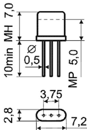
ПРИМЕР УСЛОВНОГО ОБОЗНАЧЕНИЯ: ФП2П6-616-Ш-МР-65М-60-Б КППФ.433541.006 ТУ-ДЗ
